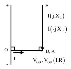
Resistive  $(X_L = X_C)$ Fig. 15.1 (d) Phasor diagram
